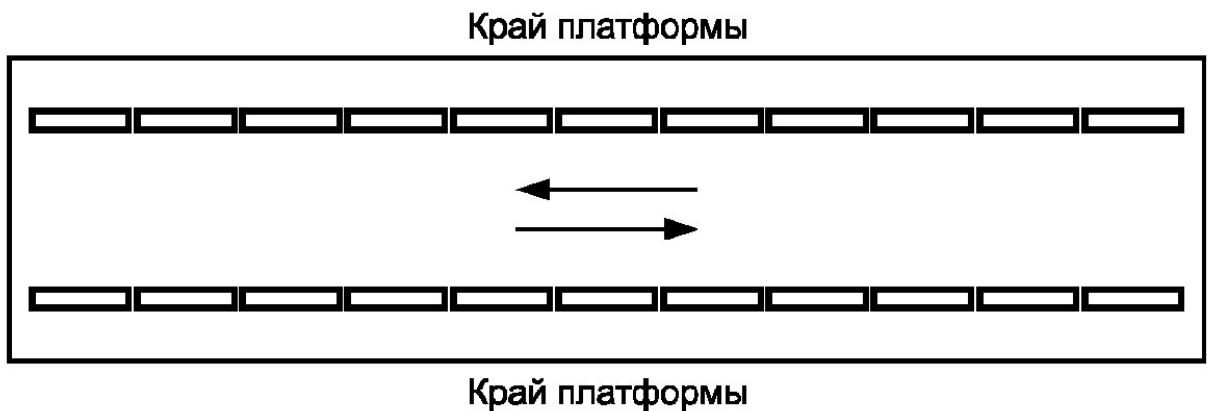
Рисунок А.4 - Форма рифления - одноэлементная тактильная полоса с плоской вершиной (шуцлингия), используемая для обустройства протяженных предупреждающих ТНУ вдоль края платформ различного назначения
