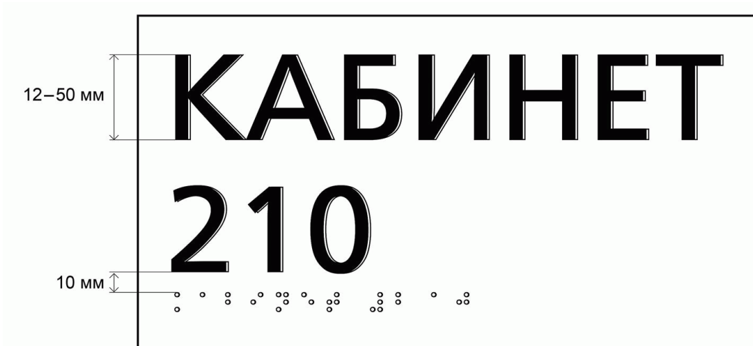
Рисунок 33 - Высота РЛШ при совмещении визуальной и тактильной информации (в данном случае знаки РТШ рекомендуется выполнять прозрачными или в цвет подложки)
